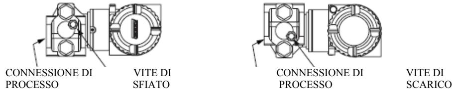
**Figura 21. Montaggio Orizzontale – Sfiato e Scarico della Cavità**
