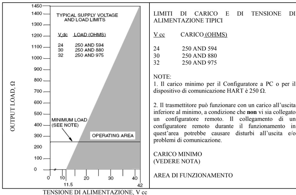
**Figura 33. Tensione di Alimentazione e Carico del Circuito**
