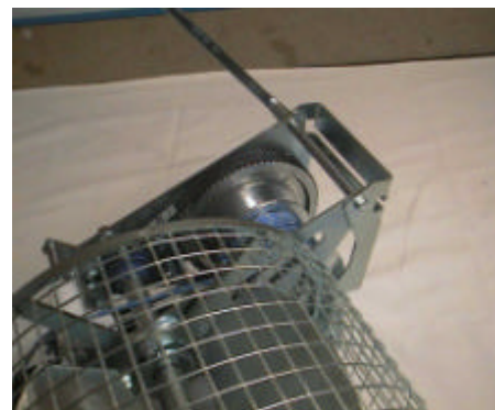
In figura il controllo viene eseguito con una chiave poligonale da 8mm A tutte le viti mostrate nella pagina precedente, ne corrispondono altrettante dal lato opposto: anche queste da controllare.
