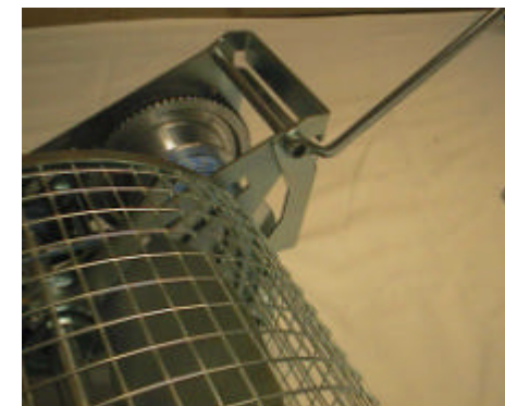
In figura il controllo viene eseguito con una chiave poligonale da 8mm A tutte le viti mostrate nella pagina precedente, ne corrispondono altrettante dal lato opposto: anche queste da controllare.
