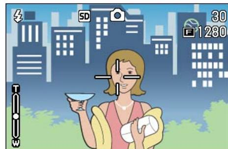
Il flash avvia la ricarica. Mentre si sta ricaricando, lo schermo LCD si spegne e la spia del flash lampeggia. A ricarica completata la spia si accende di luce fissa ed è quindi possibile eseguire la ripresa.
