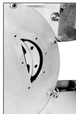
4. Svitare leggermente i bulloni di fissaggio del pattino e far scivolare il pattino dal rotore con un cacciavite o con uno strumento simile.
