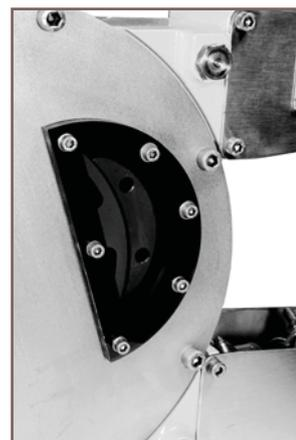
5. Smontare il pattino che non è in contatto con il tubo e rimuovere gli eventuali spessori. Controllare che il perno RIF 30 sia ancora sul rotore (da FPSH25 a FPSHX80).
