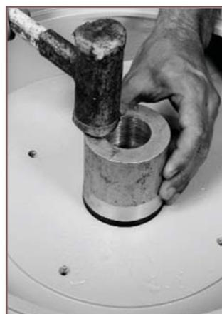
13. Montare il riduttore sul corpo facendo attenzione a non danneggiare la guarnizione dell'albero. Serrare i dadi RIF 41 con le loro rosette RIF 72.
