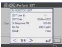
Il sensore 5000TOCi registra fino a 4 set di risultati di verifica di idoneità del sistema identificati con SST-1 (il più recente) fino a SST-4. I risultati di ciascuna di queste operazioni SST possono essere recuperati tramite il trasmettitore M800.
