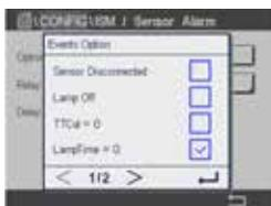
La funzione Allarme ISM/sensore consente di configurare un relè allarme per fornire un'indicazione esterna delle condizioni di allarme selezionate. Quando si verifica uno degli eventi selezionati, una barra lampeggiante rossa viene visualizzata sul trasmettitore M800 e il relè allarme, se configurato, verrà messo sotto tensione.
