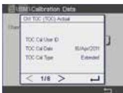
Per visualizzare le registrazioni di taratura, selezionare il canale associato al sensore 5000TOCi applicabile, la taratura e il parametro da rivedere con gli appositi selettori a tendina, quindi premere il tasto Dati tar. Usare le icone < e > per cambiare le pagine e visualizzare l'intera registrazione di taratura. Una volta visualizzata la registrazione, premere l'icona ↩ per tornare alla schermata Dati di taratura.
