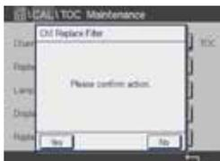
Il sensore 5000TOCi include un filtro ad alta capacità (mostrato sotto) contenente un elemento filtrante che andrebbe sostituito (codice 58 091 551, confezione da 2) dopo circa 6 mesi, in base alla qualità dell'acqua. Nel pacchetto per la sostituzione sono contenute istruzioni dettagliate per sostituire questo filtro.
