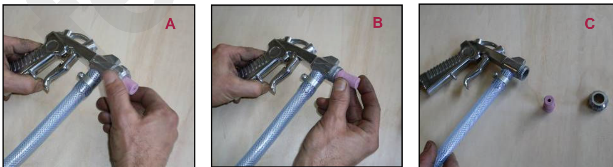
Figura 11 - Smontaggio dell'ugello della pistola sabbiatrice.
