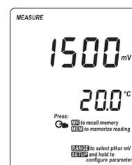
Le misure all'interno dell'intervallo  $\pm 699.9$  mV sono visualizzate con risoluzione 0.1 mV, mentre al di fuori di tale intervallo lo strumento passa automaticamente a risoluzione 1 mV.
