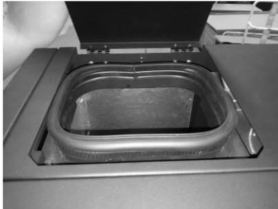
Figura 14 – Rabbocco del vano pellet
