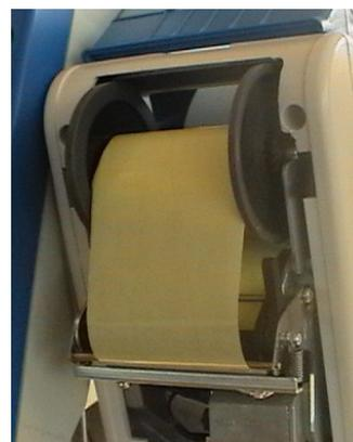
Richiudete la levetta della stampante (come per la bilancia senza riavvolgitore) e riposizionate i coperchi anteriore e posteriore.
