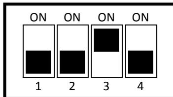
Mettendo **DIP1** su ON è possibile programmare il combinatore tramite SMS (anziché tramite software) senza che questo risponda ad ogni comando ricevuto con un SMS.
