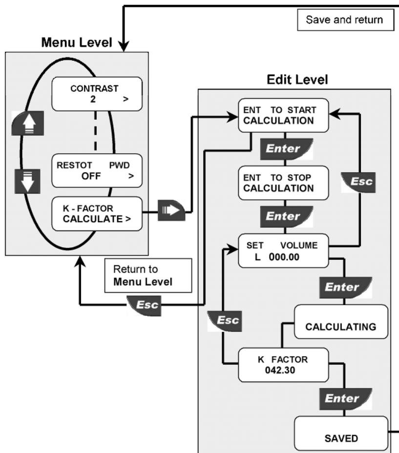
Premere ENTER per iniziare il calcolo. Avviare una pompa o aprire una valvola. L' F9.20 BD inizia a contare impulsi dal sensore.
