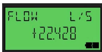
Quando la tensione della batteria è bassa, appare sul display l'indicazione di batteria scarica.
