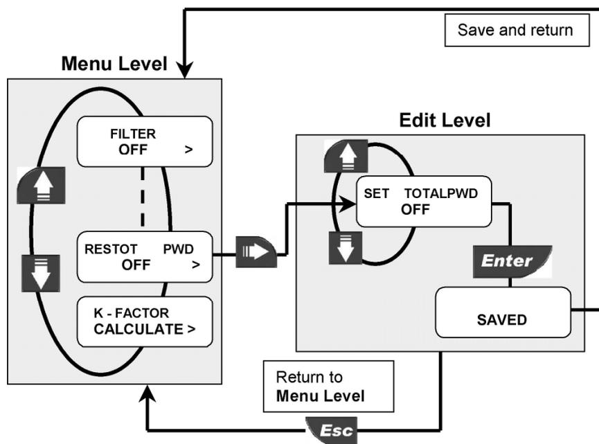
Impostare su ON per proteggere tramite password il totalizzatore resettabile da operazioni di azzeramento indesiderate.
