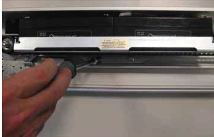
Collegare le batterie al quadro elettronico [2] mediante il cablaggio in dotazione, come indicato in figura.
