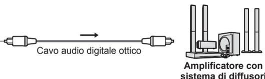
Per fruire del suono multicanale del componente esterno (ad esempio Dolby Digital 5.1ch), collegare il componente all'amplificatore. Per i collegamenti, leggere i manuali di istruzioni del componente e dell'amplificatore.
