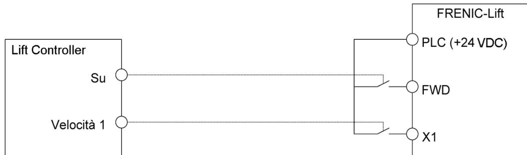
Figura 6: Collegamento normale con contatti "puliti" del "lift controller"
