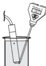
Premere il tasto COND/TEMP (HI 8633) o TDS/TEMP (HI 8734) per leggere la temperatura e regolare la manopola alla temperatura della soluzione, per es. 20°C.
