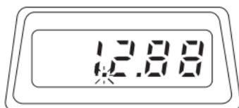
Quando appare questo indicatore, rimangono solo poche ore di vita della batteria. Una tensione insufficiente può inoltre causare letture non affidabili. Si consiglia quindi di sostituire immediatamente la batteria.
