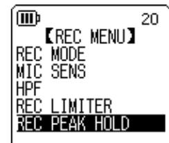
2. Premere i tasti [PLAY]/[STOP] per specificare la durata di visualizzazione del picco tra [INF] (infinito) o un valore compreso tra 0 e 10 secondi (con incrementi di 1 secondo per volta), quindi premere il tasto [REC].
