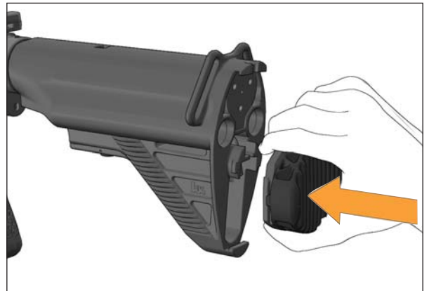
Fig. 25b: Posizionare il calciolo sul calcio
