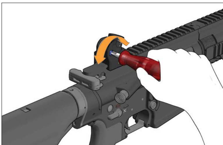
Fig. 30c: Girare la vite di regolazione laterale
