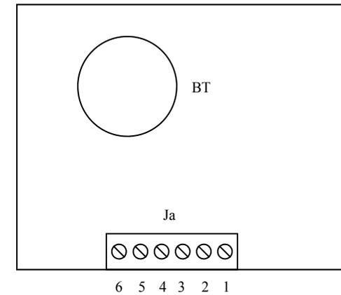
BT Batteria tampone datario: 3V modello CR2032
