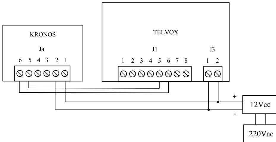
N.B. Per il corretto funzionamento, prima di collegare il timer, impostare il Telvox in stato "Giorno" (solo il led GN acceso)
