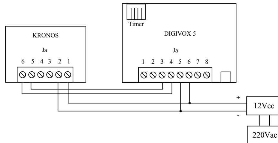
N.B. Per il corretto funzionamento, prima di collegare il timer, impostare il Digivox 5 in stato “Giorno” (sul display deve comparire il numero 1 oppure 3)
