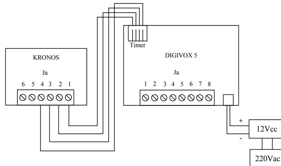
N.B. Per il corretto funzionamento, prima di collegare il timer, impostare il Digivox 5 in stato “Giorno” (sul display deve comparire il numero 1 oppure 3)
