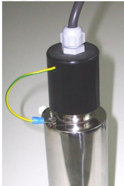
11. Riempire di acqua il collettore (se già non lo è). Dare tensione e far scaldare la lampada per 4/5 minuti; far scorrere la prima acqua per altri 2/3 minuti. A questo punto è possibile utilizzare l'acqua prodotta.
