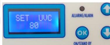
Opzione SET N oppure SET Y = impostazione del pilotaggio del relè di accensione ballast in caso di intervento di allarme (di default N, quindi in caso di allarme non vengono spente le lampade). Se si vuole che in caso di allarme le lampade vengano spente opzionare Y
