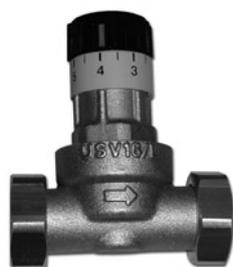
E' di primario costruttore (WATTS) con corpo in ottone PN10 e estremità filettate gas femmina  $\varnothing 3/4''$ . La tenuta è con o-ring; il volantino è regolabile per impostare il valore di taratura. La figura seguente riporta il grafico portata-perdita di carico in funzione della posizione di apertura. Il campo lavoro utilizzato è indicativamente fino ad una pressione differenziale di 30 kPa (0,3 bar).
