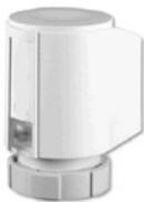
Il servocomando modulante applicato alla valvola miscelatrice a tre vie nei satelliti serie M è di tipo flottante bidirezionale con comando a 3 punti con alimentazione 230 V/50 Hz, potenza massima assorbita 6W, tempo di apertura 100 s.
