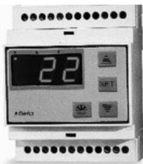
Il regolatore climatico per i satelliti serie M è alloggiato in un contenitore modulare in plastica per installazione su barra DIN. Il pannello frontale è dotato di display ad alta intensità e tasti di programmazione; il regolatore è dotato di 2 ingressi per sensori a semiconduttori PTC (990 ohm a 25°C) per il rilievo della temperatura esterna e della temperatura di mandata del circuito idraulico. Il regolatore tramite le 2 uscite a relè pilota il servocomando della valvola miscelatrice a 3 vie.
