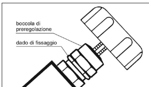
Fig. 2.4 - Procedura di pre-regolazione valvola di taratura
