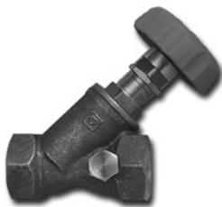
E' di primario costruttore (HERZ) con corpo in bronzo PN16 ed estremità filettate gas femmina  $\varnothing 3/4''$ . La tenuta è con o-ring sul corpo e con PTFE sulla sede. Il volantino è regolabile con possibilità di bloccare la posizione di regolazione, in questo modo la valvola può essere utilizzata anche come dispositivo d'intercettazione con apertura solo fino al punto di regolazione.
