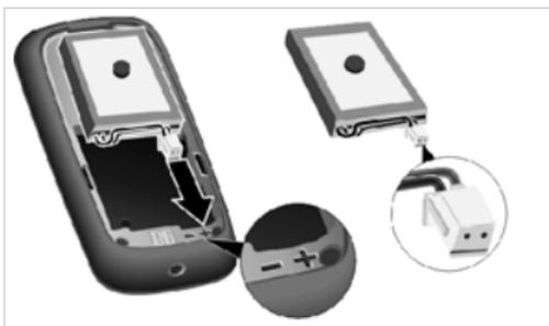
È necessario posizionare il connettore in modo tale che il cavetto **rosso** si trovi sul lato esterno del vano batteria, lato contrassegnato con **+** ed il cavetto **nero** si troverà ovviamente verso l'interno del vano batteria, lato contrassegnato con **-**.
