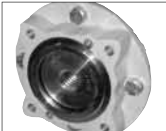
Fig. 5 . 5 Madrevite in bronzo montata nella base reggispinta
