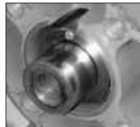
Fig. 12 Madrevite tipo A pos.2
