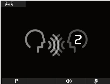
Durante la **comunicazione in corso** è possibile escludere il microfono premendo il tasto D.
