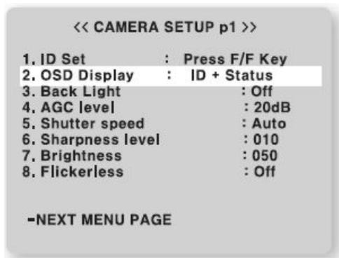
La funzione OSD Display abilita la visualizzazione a monitor del nome assegnato alla telecamera nell'opzione **ID Set** e l'eventuale funzione correntemente attivata.
