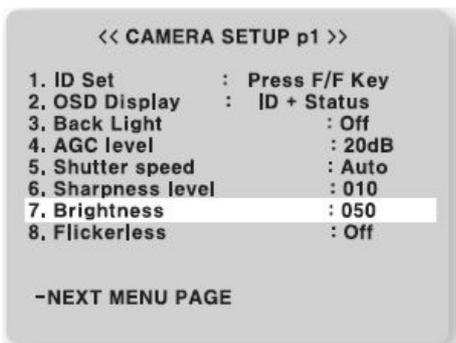
Questa funzione consente di effettuare una fine regolazione del livello di luminosità dell'immagine mostrata a monitor, regolando ulteriormente il livello di apertura dell'iride della telecamera. Il valore di riferimento è 14.
