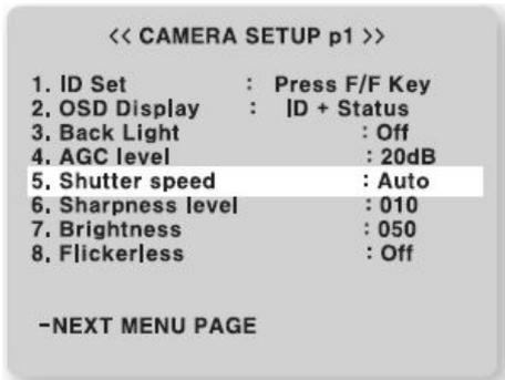
La voce Shutter Speed consente di variare la velocità di esposizione del sensore della telecamera alla luce. La programmazione consente di impostare il valore automaticamente (AUTO) o manualmente specificando uno specifico valore numerico:
