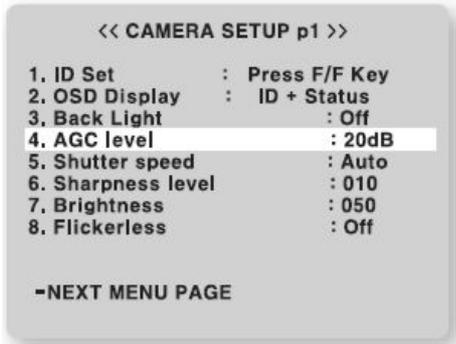
La funzione AGC (Automatic Gain Control) consente di regolare automaticamente l'amplificazione del segnale video in modo che l'uscita video risulti sempre pari al valore standard di  $1V_{pp}$ .
