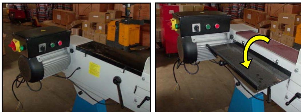
Figura 13 – Aprire il coperchio superiore.
