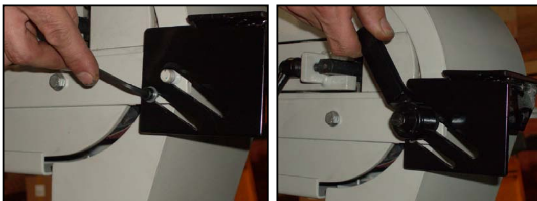
Figura 15 – Montaggio appoggia-pezzo anteriore.
