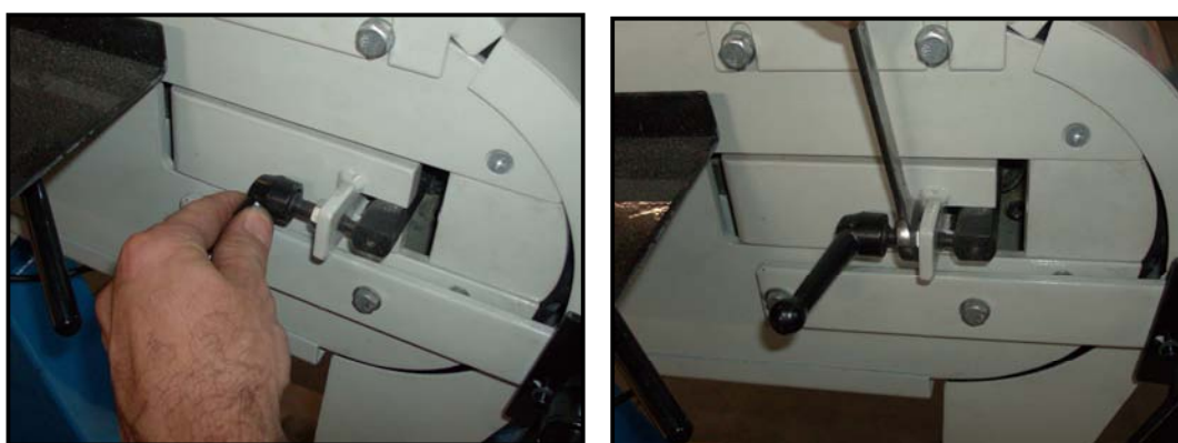
Figura 6 – leva di rilascio della tensione del nastro.
