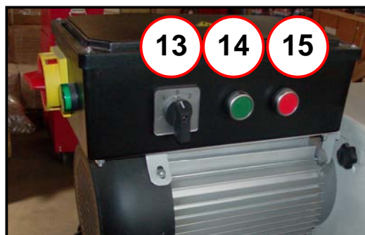
Figura 12 – Dettaglio interruttori motore.
