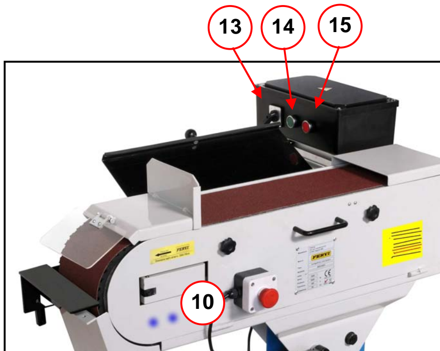
Figura 3 – Pulsanti e selettori di comando sul quadro elettrico.
