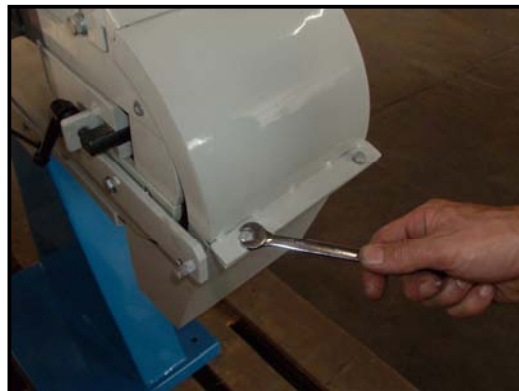
Figura 14 – Smontare il carter anteriore.
