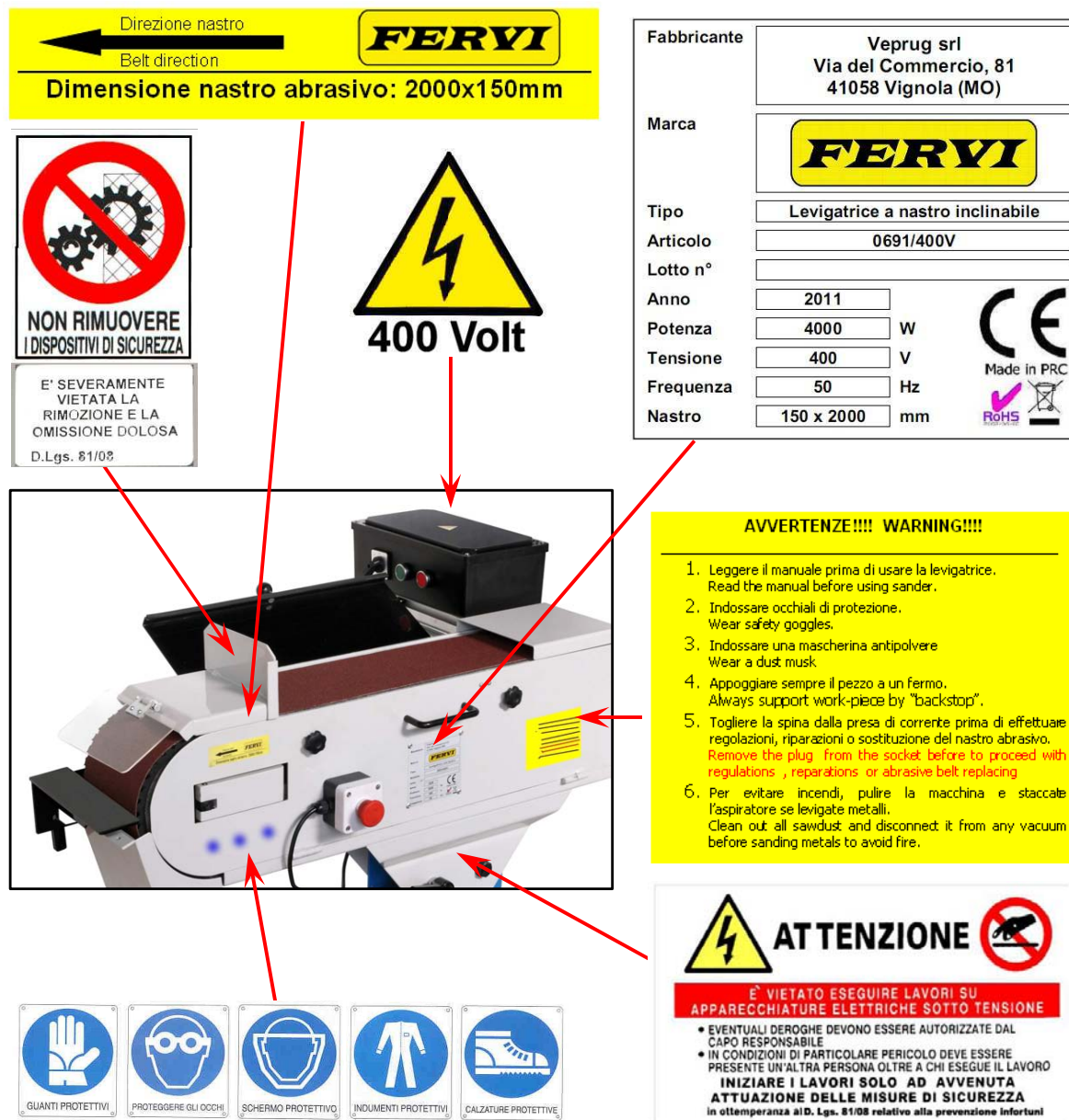
Figura 2 – Targhetta di identificazione e pittogrammi.
