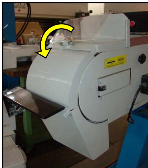
Figura 16 – Regolare il para-occhi.
