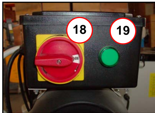
Figura 11 – Dettaglio interruttore generale.
