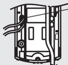
Applicare il sigillante (silicone, ecc.) sul foro di passaggio cavo per sigillarlo completamente. Applicare anche la stessa modalità al rivelatore corrispondente.
