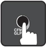
10. A questo punto per ultimare la calibrazione a 2 punti premere il tasto CAL. Lo strumento memorizzerà i nuovi dati di calibrazione e tornerà automaticamente alla modalità di misura pH. Se invece desiderate completare la calibrazione a 3 punti, selezionare il valore di +1800 mV sul simulatore.
