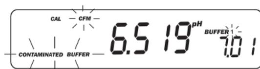
Il messaggio "CONTAMINATED BUFFER" lampeggiante segnala che la soluzione tampone è stata contaminata da un'altra soluzione oppure da residui.
