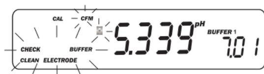
Quando il display visualizza il messaggio "CHECK BUFFER" lampeggiante significa che la composizione chimica della soluzione tampone si è alterata a causa di una errata conservazione oppure perchè la soluzione è scaduta.
