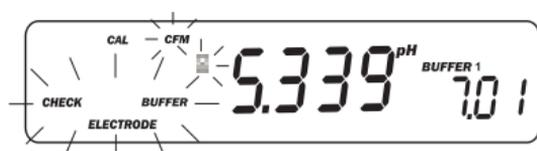
Quando il display visualizza il messaggio "CHECK ELECTRODE" lampeggiante segnala che la superficie in vetro dell'elettrodo può presentare punti di rottura, incrinature o graffi.
