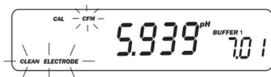
Quando il display visualizza il messaggio "CLEAN ELECTRODE" lampeggiante significa che il bulbo sensibile presenta incrostazioni, residui o aloni che impediscono una corretta misura.
