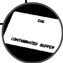
La soluzione tampone può essere contaminata. Sostituire la soluzione con una nuova;
