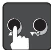
**Nota:** Se il valore è troppo inferiore o superiore al valore visualizzato sul livello secondario il display visualizzerà il messaggio "WRONG" lampeggiante. Riverificare la temperatura del bagno e se necessario sostituire la sonda di temperatura dello strumento.
