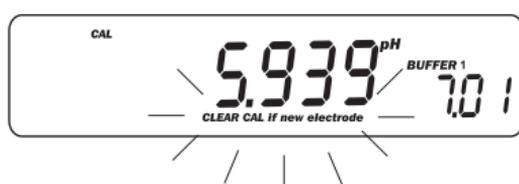
Il messaggio "CLEAR CAL IF NEW ELECTRODE" lampeggiante viene visualizzato ogni volta che si entra in modalità di calibrazione, richiede all'operatore se si utilizzerà un elettrodo nuovo oppure se si desidera cancellare i dati di calibrazione memorizzati nella precedente calibrazione.
