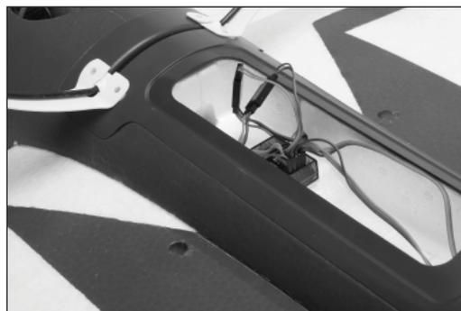
**Nota:** non vi è alcuna differenza tra le due connessioni del cablaggio aY. I connettori dei cavi del servo di sinistra e di destra possono essere collegati in modo indifferente su uno o l'altro connettore della prolunga aY.
