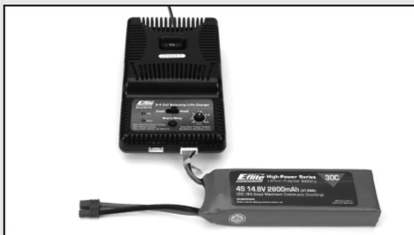
**AVVERTENZA:** l'uso di un caricabatteria inappropriato per la batteria Li-Po può causare gravi danni e se sufficientemente prolungato provoca un incendio. Prestare SEMPRE attenzione durante la carica di batterie Li-Po.
