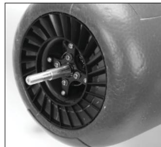
7. Rimuovere la boccola dell'adattatore dell'elica dall'albero motore.
