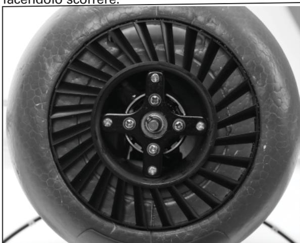
• Vista anteriore delle viti sul montante del motore
