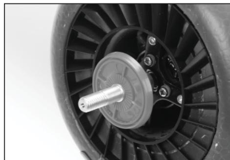
5. Rimuovere la piastra di copertura dello spinner dalla boccola dell'adattatore dell'elica.
