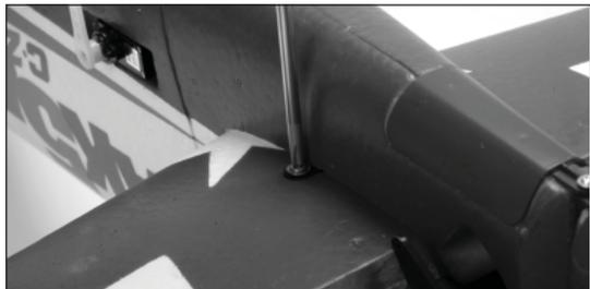
3. Rimuovere le viti situate sull'asse cardine alla base dello stabilizzatore orizzontale.
