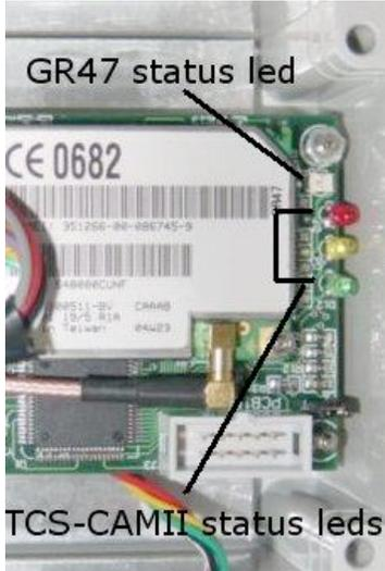
La TCS-CAMII ha 4 leds; 3 (rosso giallo e verde) sono dedicati al funzionamento della TCS-CAMII stessa, il quarto (il GR47 status led) è pilotato direttamente dal modulo GSM GR47.
