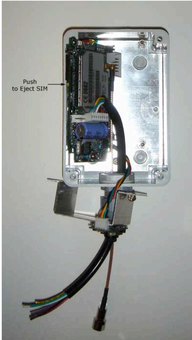
Per inserire la SIM all'interno della TCS-CAMII occorre rimuovere il supporto della telecamera e svitare le 4 viti che fermano la scheda. Il porta SIM è posto al di sotto di quest'ultima.
