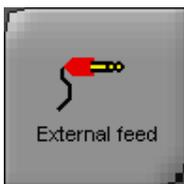
Richiama la commutazione di una Linea esterna, che viene caricata in scaletta allo stesso modo di un qualunque clip video. Durante l’esecuzione di un elemento “Line In”, viene aperto il canale corrispondente sulla matrice di commutazione in base a quanto impostato in fase di setup del sistema.
