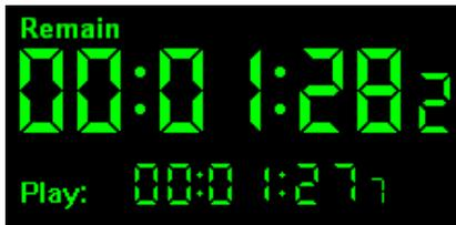
Indica il tempo rimanente alla fine del clip video. Se Moviejay è impostato in modalità Auto Sequence ed in scaletta è presente almeno un altro elemento, l'indicazione tiene conto del punto di Fade-Out impostato per l'elemento in riproduzione (l'indicazione 0:00:00.0 del display coincide cioè con il Fade-Out); diversamente, il conteggio a ritroso
