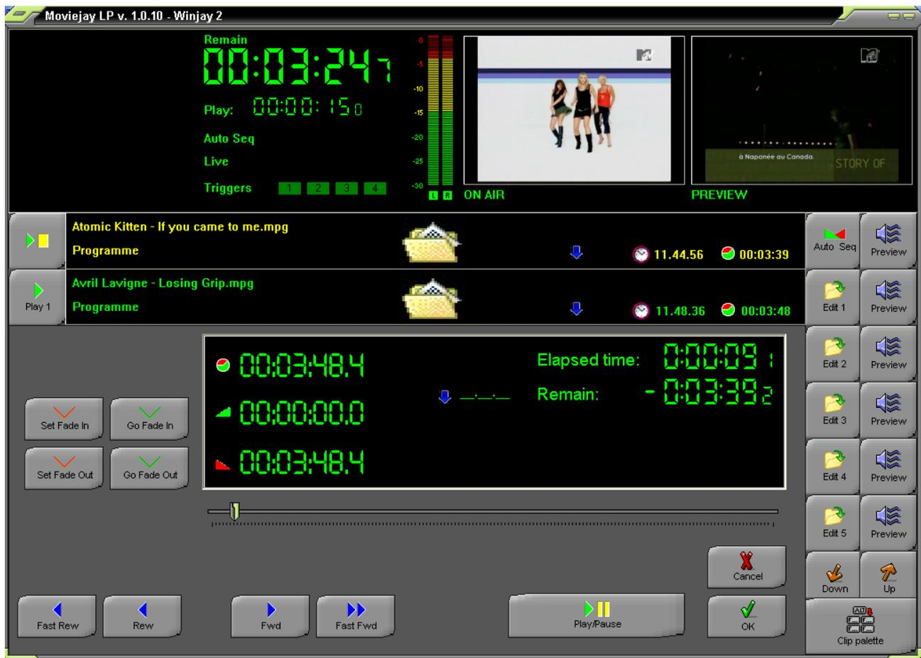
Premendo gli appositi pulsanti dalla finestra on air, nella zona inferiore dello schermo appare la finestra preview, che consente di visionare su finestra VGA i corrispondenti elementi in scaletta oltre che variare i marker di fade-in e fade-out di un elemento in scaletta pur conservando le impostazioni effettuate in fase di archiviazione.
