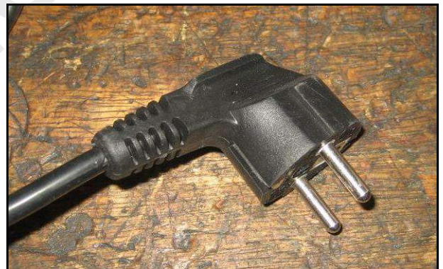
Figura 9 – Particolare spina di alimentazione.
