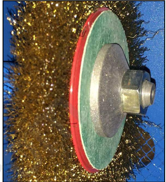
Figura 18 – Dado e flangia di fissaggio.
