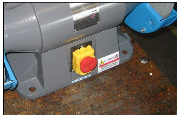
Figura 4 – Dettaglio fori di fissaggio.
