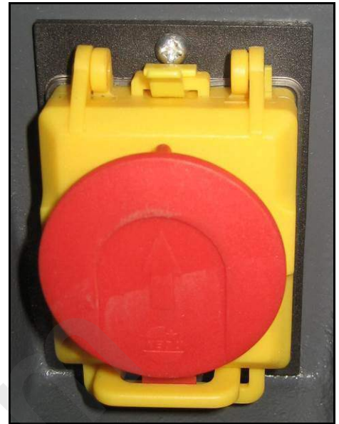
Figura 13 – Calottina di arresto di emergenza.
