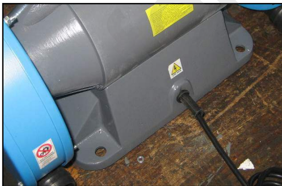
Figura 4 – Dettaglio fori di fissaggio.
