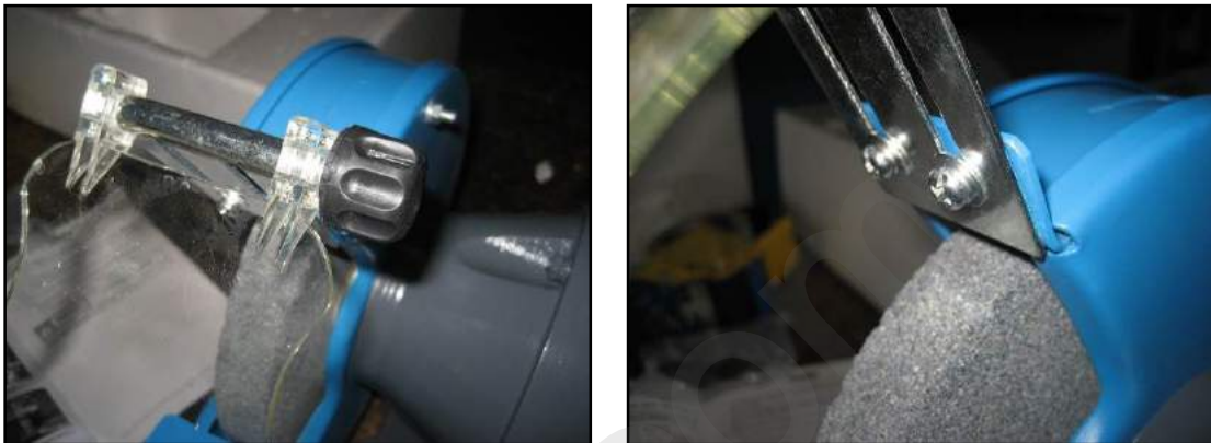
Figura 5 – Montaggio degli schermi di protezione.
