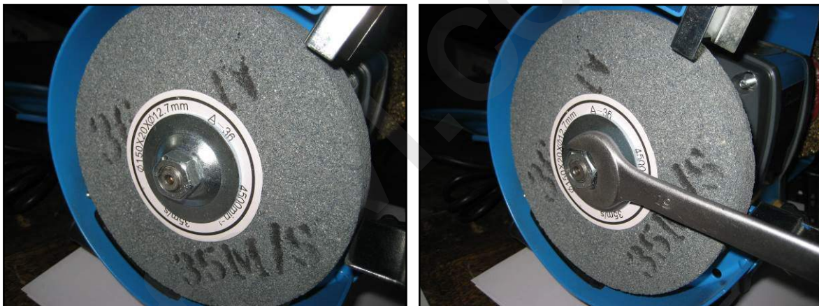
Figura 17 – Dado e flangia di fissaggio della mola.
