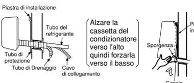
Il cavo di collegamento, il tubo e il condotto di drenaggio devono essere legati assieme con un nastro isolante.
