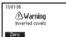
Cuvette invertite: Sono state invertite le cuvette dello zero (bianco) e campione.
