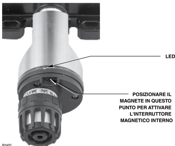
Figura 13—Posizione dell'interruttore magnetico sul rivelatore GT3000
