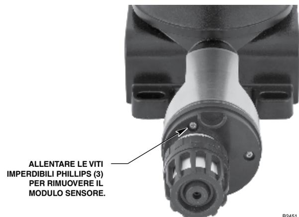
Figura 15—Posizione delle viti per la sostituzione del modulo sensore
