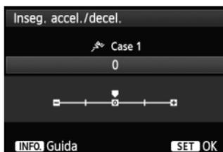
Consente di impostare la sensibilità inseguimento per soggetti in movimento la cui velocità può cambiare, ad esempio se il soggetto parte o si ferma improvvisamente.
