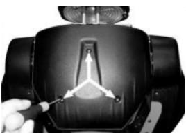
2) Con l'ausilio di un cacciavite a stella svitate le sei viti di fissaggio dei coperchi sinistro e destro del corpo proiettore.
