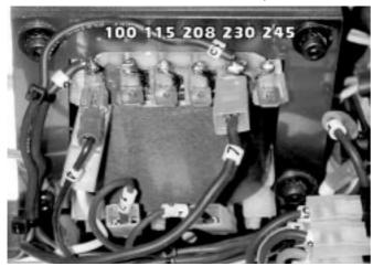
4) Se la tensione da voi settata è 100 o 115V sostituite il fusibile da 5 Amps T ,adatto alla selezione 208/230/245 V, con uno da 8 Amps T nel portafusibile sulla base del proiettore e viceversa.
