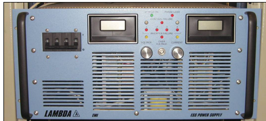
Fig.5: vista frontale dell'alimentatore (power supply)
