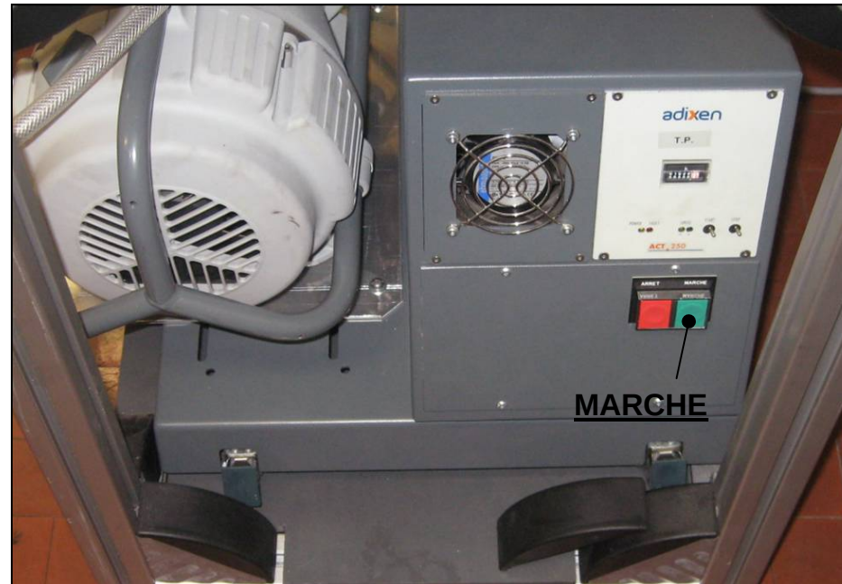
Fig.4: vista frontale della pompa turbomolecolare
