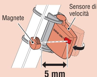
\* Il magnete può essere montato in qualsiasi posizione sul raggio se vengono soddisfatte le condizioni di fissaggio.
