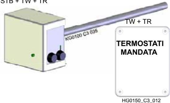
La regolazione del bitermostato TW+TR, posto sul canale di mandata del generatore, avviene aprendo la scatola che contiene i termostati e agendo sulla vite con il cacciavite.
