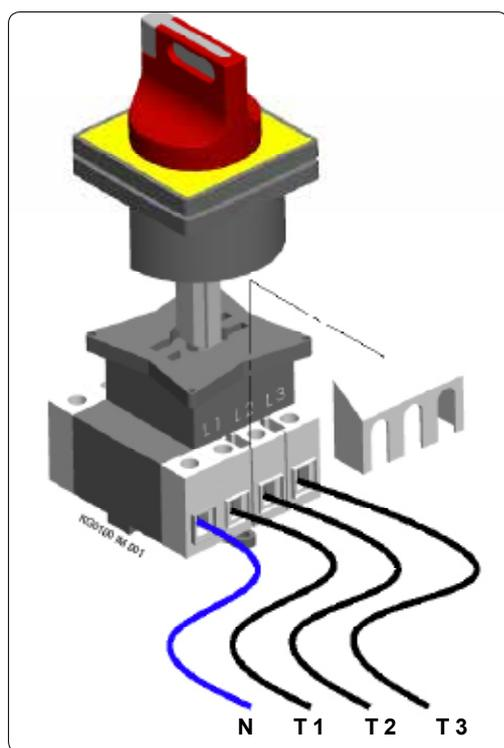
**IMPORTANTE:** A monte del quadro elettrico del generatore, deve essere installato un interruttore munito di protezione, fusibili o automatica, come previsto dalla normativa vigente.
