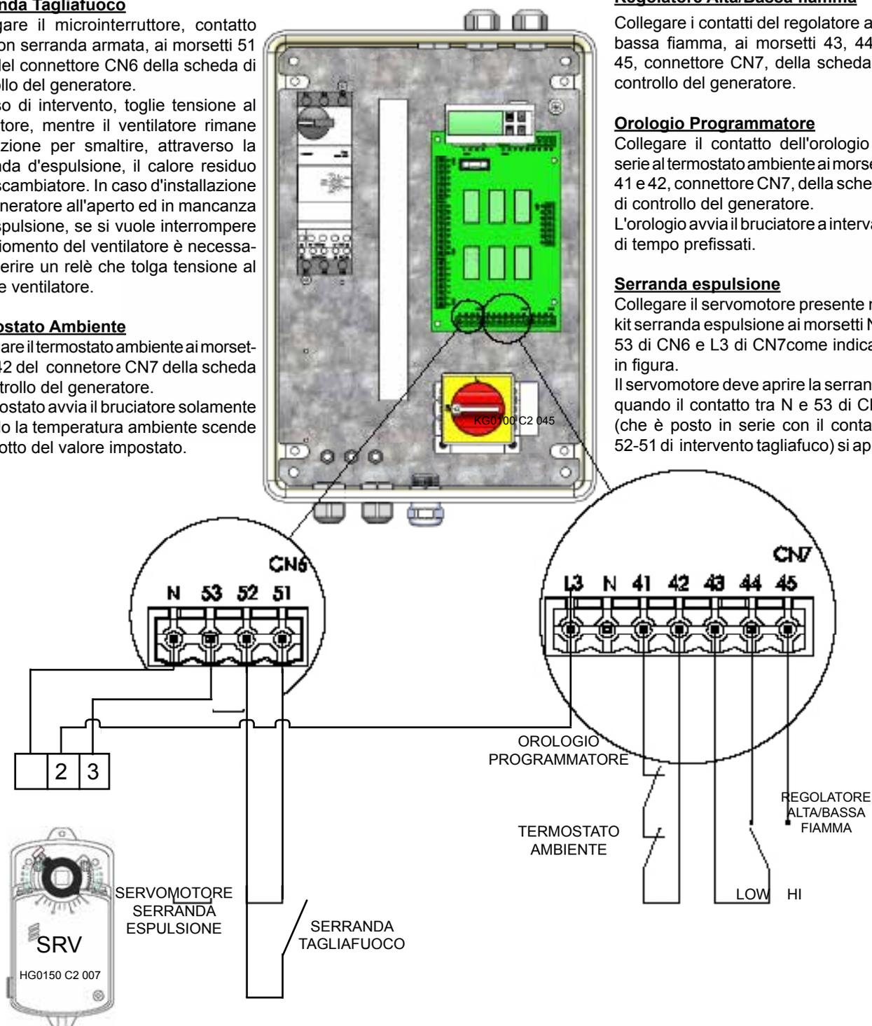
**Importante:** in mancanza della serranda tagliafuoco ponticellare i morsetti 51, 52, connettore CN6. E' obbligatorio il collegamento di un termostato ambiente, il bruciatore funziona solo se i morsetti 41 e 42 sono chiusi. Eseguire collegamento alta/bassa fiamma solo in presenza di bruciatore bistadio; in mancanza di un regolatore bistadio e in presenza di un bruciatore bistadio, ponticellare i morsetti 43, 44 del connettore CN7.
