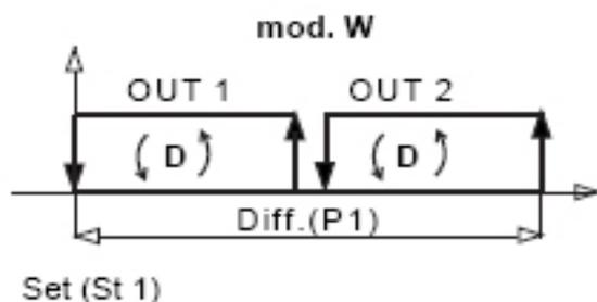
sonda supera il set point si apre la serranda aria esterna e entra aria esterna per diminuire il valore di umidità nell'ambiente. Il funzionamento è del tipo Direct, led verde lampeggiante.
