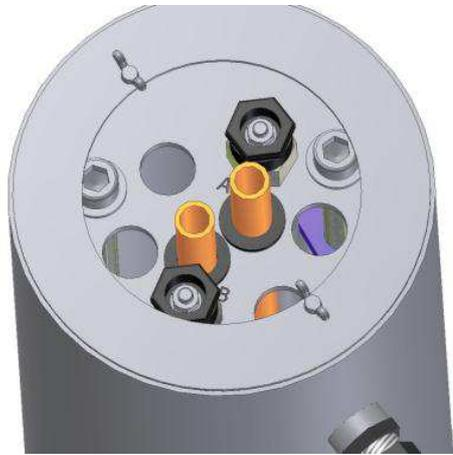
Terminata l'iniezione di cemento tagliare i tubi d'iniezione il più vicino possibile alla piastra.
