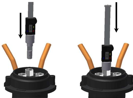
Inserire il calibro come in figura, appoggiarlo sulla ghiera cromata e spingere l'asta fino ad arrivare a battuta. Annotare il valore del display.
