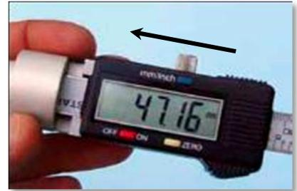
Accendere il calibro, selezionare l'unità di misura (mm o inch). Portare il calibro a battuta ed azzerare con il pulsante ZERO.
