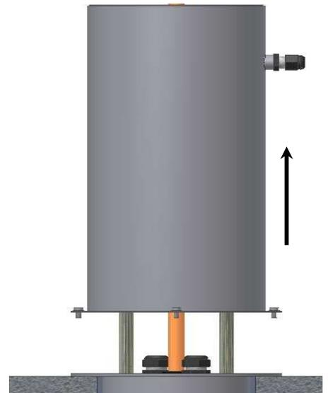
Rimuovere la protezione metallica della testa di misura, fissata con quattro viti (chiave a brugola n° 4)
