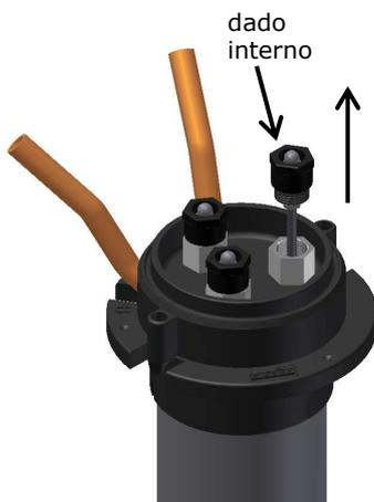
Quando il cemento ha fatto presa, sbloccare le aste di misura svitando prima il tappo di blocco nero e poi il dado interno. Ora l'asta è libera di scorrere nella guaina. Si possono montare i trasduttori o eseguire le letture con il calibro digitale.
