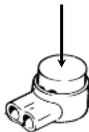
Con i morsetti in dotazione giuntare i conduttori dei trasduttori con quelli del cavo multipolare.
