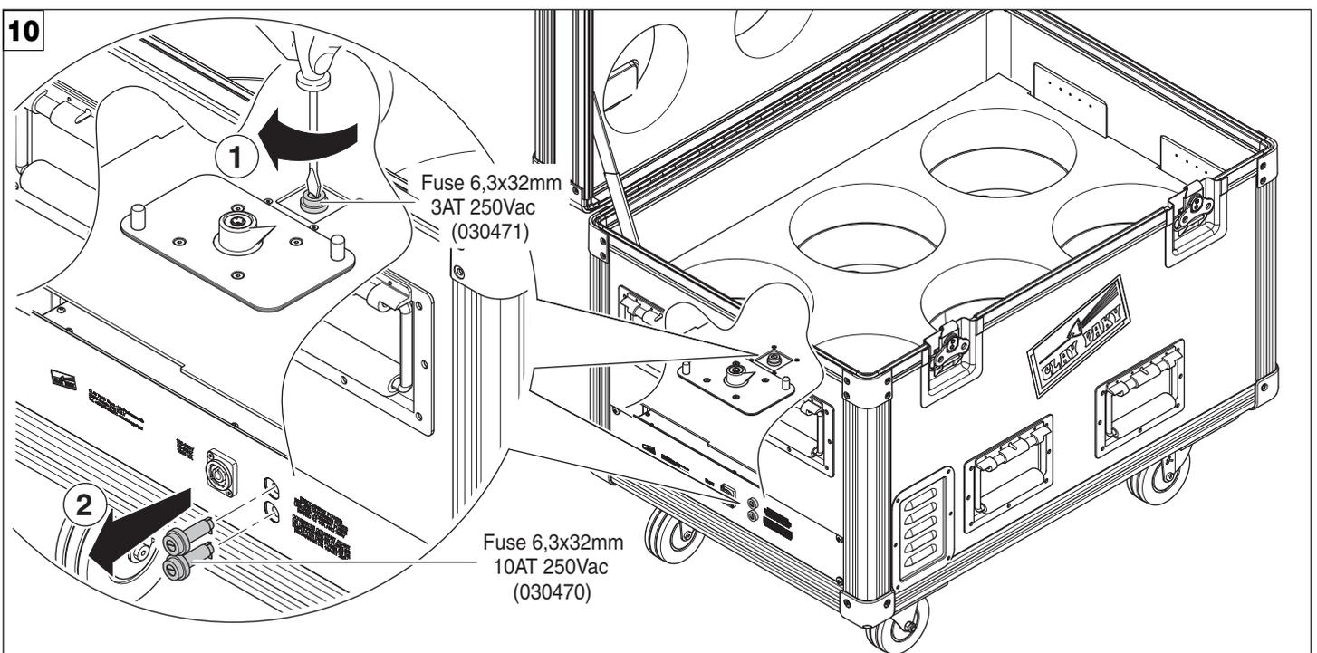
Sostituzione fusibili FLIGHT CASE - Fig. 10
