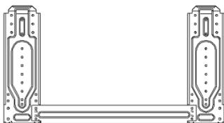
Per il posizionamento assicurarsi di avere muri solidi. Usare cacciavite adatti (tipo "+") per velocizzare il fissaggio della staffa di supporto. Usare una livella a bolla per un livellamento perfetto sia orizzontale che verticale. Posizioni errate di montaggio possono comportare perdite di acqua durante il funzionamento.
