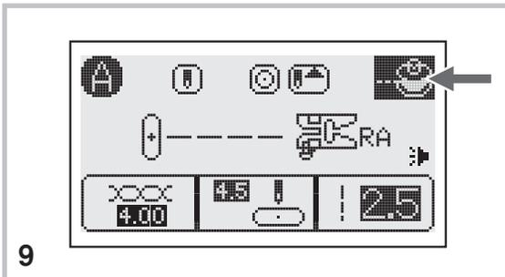
9. Spingendo a sinistra l'interruttore dell'annaspatoio e premendo il tasto dell'annaspatoio, il display LCD visualizza l'animazione dell'avvolgimento della bobina.
