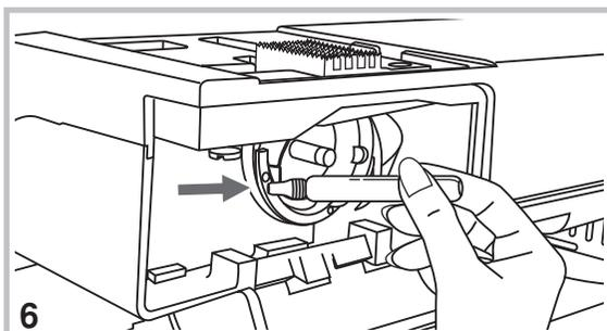
6. Applicare una goccia di olio (ogni 15 o 20 ore di funzionamento) sul crochet come mostrato in figura.
