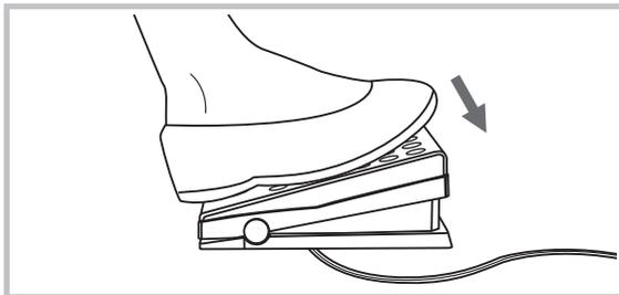
Accendere la macchina per cucire e premere lentamente il comando a pedale per iniziare a cucire.
