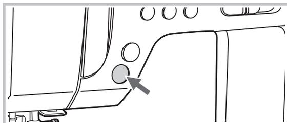
La macchina entra in funzione premendo il tasto AVVIO/ARRESTO e si ferma premendolo una seconda volta. All'inizio la macchina cuce lentamente. La velocità di cucitura è controllabile tramite il relativo comando.
