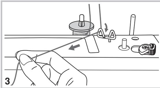
3. Posizionare il filo nell'apposita apertura del guidafile sul portarocchetto utilizzato.
