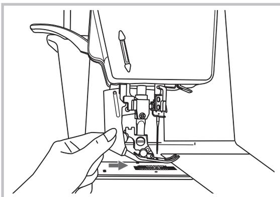
Spostare in avanti il meccanismo DFS sotto la parte posteriore del piedino in modo da innestarlo e mantenerlo in posizione abbassata.
