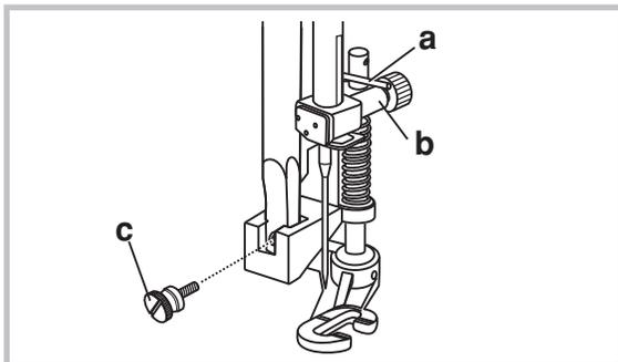
Rimuovere la staffa di supporto del piedino e inserire il piedino di rammendo sulla relativa asta. Il perno (a) deve trovarsi sulla vite (b) morsetto ago. Premere saldamente sul piedino di rammendo da dietro con l'indice e serrare la vite (c).
