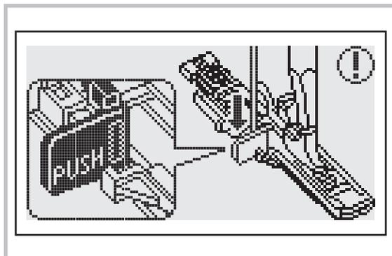
**Nota:** quando si inizia a cucire un motivo asole prima di abbassare la relativa leva, il display LCD visualizza il messaggio di avvertenza animato che ricorda di abbassare la leva.
