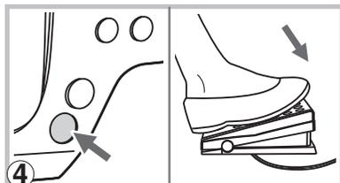
4. Premere il comando a pedale o premere il tasto AVVIO/ARRESTO per avviare la macchina per cucire.
