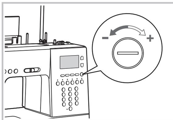
Il controllo luminosità del display LCD è situato a destra del display stesso e deve essere utilizzato per regolarne la definizione.
