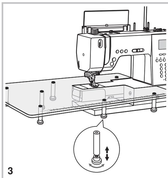
3. Tenere il piano allungabile a livello, farlo scorrere in alto verso la macchina per cucire. Per regolare l'altezza del piano allungabile, ruotare i supporti di gomma sotto ogni piedino all'altezza idonea.
