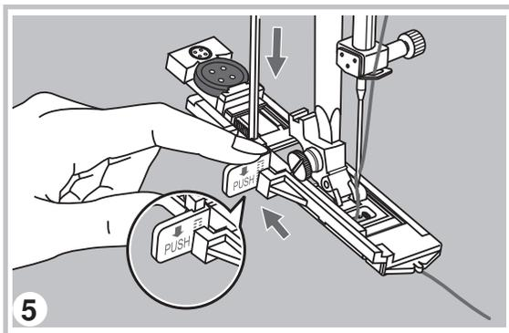
5. Passare il filo superiore in basso attraverso il foro nel piedino. Abbassare la leva per occhielli e posizionare dietro la staffa del piedino delle asole. Tenere delicatamente l'estremità del filo superiore nella mano sinistra e iniziare a cucire.
