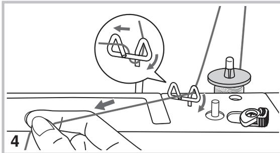
4. Posizionare il filo attraverso l'apposita apertura del guidafilo del portarocchetto utilizzato.
