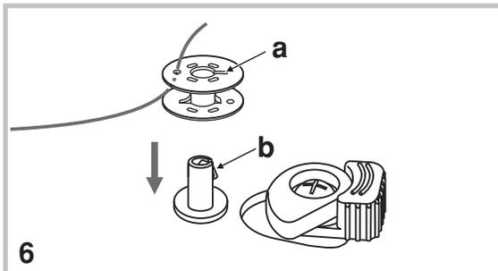
6. Posizionare l'estremità del filo in uno dei fori interni della bobina, come in figura. Allineare la scanalatura (a) nella bobina con la molla (b) sull'alberino dell'annaspatoio e posizionare la bobina vuota sull'alberino dell'annaspatoio.
