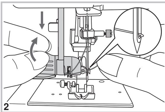
2. Ruotare l'infilata ago in posizione di inserimento del filo in modo che il perno di aggancio attraversi la cruna dell'ago.
