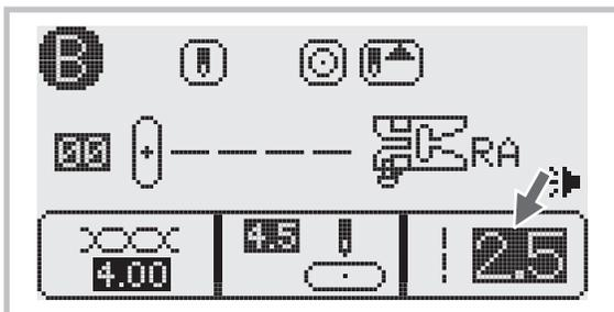
Quando si seleziona un punto, la macchina imposta automaticamente la lunghezza del punto consigliata, indicata dai numeri sul display LCD e regolabile premendo i tasti di regolazione lunghezza punto.
