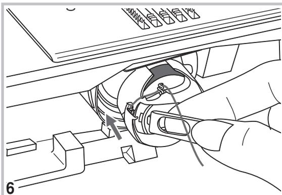
6. Tenere la scatola bobina per il chiavistello. Inserire la scatola bobina nel crochet e sganciare il chiavistello.
