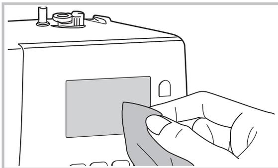
**⚠ Attenzione:** staccare il cavo di alimentazione dalla presa a muro prima di pulire il display LCD e la superficie della macchina per cucire, per evitare lesioni o scosse elettriche.
