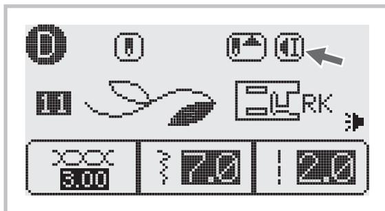
Per arrestare la macchina alla fine del motivo corrente o cucire un singolo motivo (tranne Motivi 00-05, 27-49 Gruppo 2-B e Motivi 00-02, 04, 18 Gruppo 3-C), premere il tasto fissaggio automatico; la macchina cuce 3 punti di fissaggio alla fine del motivo corrente e si arresta automaticamente.
