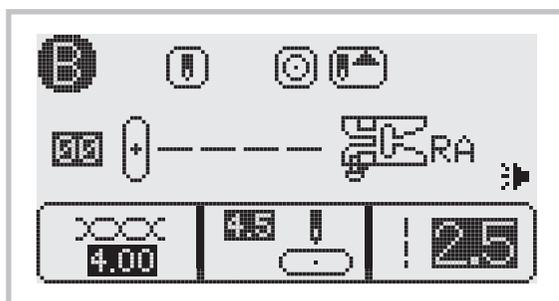
Quando si selezionano i Motivi 00-05, 45 Gruppo 2-B e i Motivi 01-02, 04, 18 Gruppo 3-C, la macchina cuce immediatamente 3 punti di fissaggio premendo il tasto fissaggio automatico, quindi si arresta automaticamente.
