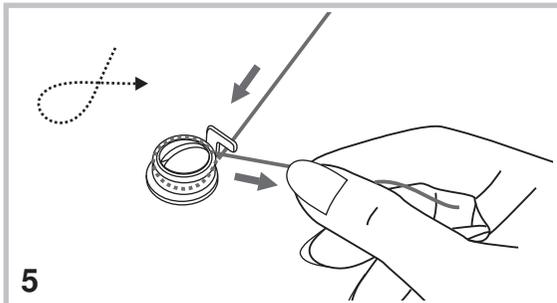
5. Passare il filo in senso orario attorno al disco di tensione dell'avvolgimento della bobina, come in figura. Accertare che il filo sia ben fissato sotto il disco.
