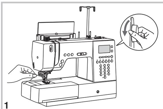
1. Tenere il filo superiore con la mano sinistra. Ruotare il volantino verso se stessi (in senso antiorario) abbassando e rialzando l'ago.
