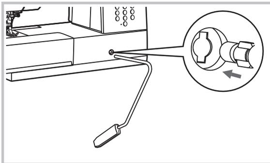
La leva a ginocchio è molto utile per cucire applicazioni, patchwork e trapunte in quanto consente di manipolare il tessuto controllando il piedino con il ginocchio. Accoppiare le nervature sulla leva a ginocchio con gli incavi nella relativa presa e inserire la leva a ginocchio.
