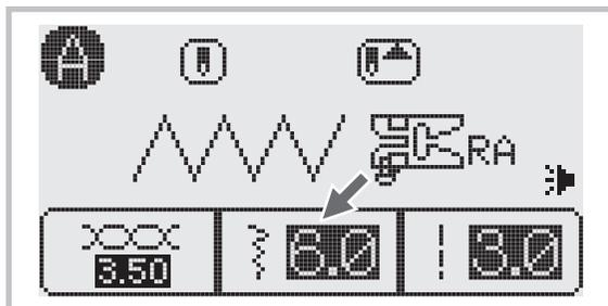
Quando si seleziona un punto, la macchina imposta automaticamente la larghezza del punto consigliata, indicata dai numeri sul display LCD e regolabile premendo i tasti di regolazione larghezza punto.
