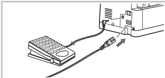
A macchina per cucire spenta, inserire la spina del comando a pedale e il cavo di alimentazione nei relativi connettori sulla macchina.
