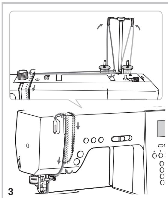
3. Infilare il rocchetto di filo destro attraverso la scanalatura del filo superiore, nel guidafile del porta ago e quindi manualmente nella cruna dell'ago destro (l'infilatura non è utilizzabile con l'ago gemello).
