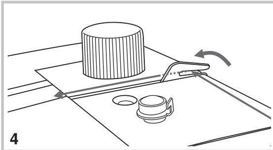
4. Inserire il filo nel guidafile di pre-tensionamento tirandolo attraverso la relativa molla come in figura.
