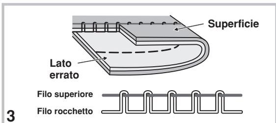
3. Tensione del filo superiore eccessiva per la cucitura a punto diritto. Premere il tasto “-” fino al numero inferiore successivo per ridurre la tensione.
