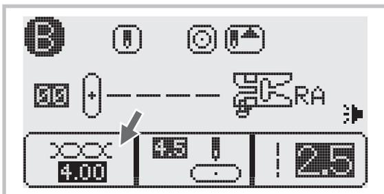
Quando si seleziona un punto, la macchina imposta automaticamente la tensione del filo consigliata, indicata dai numeri sul display LCD e regolabile premendo i tasti di regolazione tensione.
