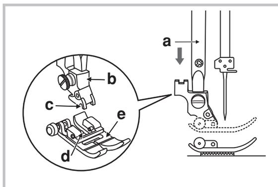
Abbassare la staffa di supporto del piedino (b) in modo che l'incavo (c) sia proprio sopra il perno (d).
