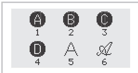
All'accensione della macchina il display LCD è impostato in modalità diretta A. Premendo il tasto "FUNC", il LED si accende e il display LCD visualizza automaticamente la schermata del gruppo di motivi. Premere i tasti numerici corrispondenti al gruppo di punti. Per esempio, premere FUNC e 2 per il gruppo B, quindi premere il numero di motivo a 2 cifre nel gruppo B sulla tabella dei punti.
