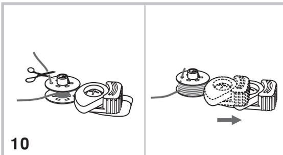
10. Quando la bobina ha compiuto alcune rotazioni riavvolgendosi, arrestare la macchina e tagliare il filo vicino al foro della bobina. Continuare ad avvolgere la bobina fino al riempimento. La bobina interrompe automaticamente il proprio avvolgimento quando è piena e l'interruttore dell'annaspatoio torna in posizione iniziale.
