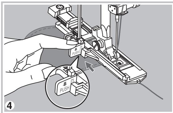
4. Passare il filo superiore in basso attraverso il foro nel piedino. Abbassare la leva per occhielli e posizionare dietro la staffa del piedino per occhielli. Tenere delicatamente l'estremità del filo superiore nella mano sinistra e iniziare a cucire.
