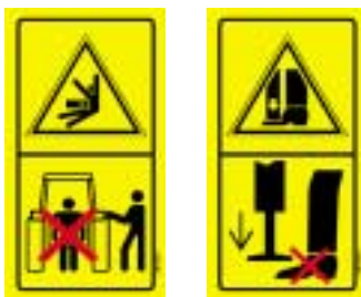
Fig. 5 - Esempio di pittogrammi richiamanti l'attenzione sui rischi connessi all'accoppiamento ed al disaccoppiamento della macchina alla trattrice.
