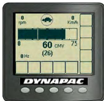
Fig. Display del compattometro (display CMV)
