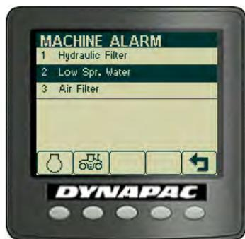
**"MACHINE ALARM" (allarme macchina)**
