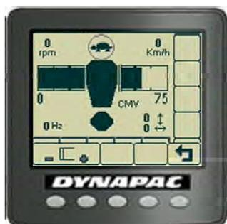
Successivamente, l'ABC interrompe le vibrazioni e comunica all'operatore di continuare la compattazione impostando un'ampiezza delle vibrazioni inferiore, oppure, se è disponibile la frequenza variabile, riducendo la frequenza delle vibrazioni.
