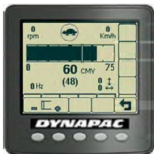
La schermata CMV nel display darà all'operatore tutte le informazioni richieste durante la compattazione: il regime del motore, la posizione del cambio, la frequenza e le inclinazioni, nonché il valore CMV effettivo e il limite impostato tra parentesi. Utilizzare i pulsanti sotto al display per impostare il limite. La scala passa automaticamente da 0-75 a 0-250 e viceversa, in funzione della lettura CMV.
