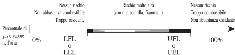
Figura 5. Domini di infiammabilità e di esplosività
