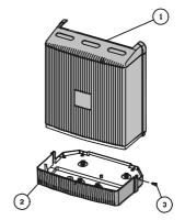
Figura 24. Rimozione della bacinella di condensa Modello da 4,1 KW
