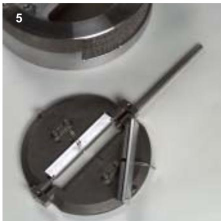
Inserire le nuove molle con le piastre di tensione. Montare i perni e le piastre di fissaggio.
