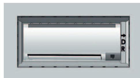
**4.2.3** Fissare il convogliatore dell'aria sulla parete inferiore dell'ALABOX e ALABOX-C tramite le tre viti di fissaggio in dotazione (**fig. 3**).
