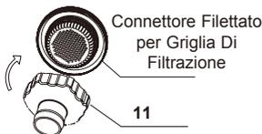
Avvitare l'adattatore del tubo B (11) al connettore d'inserimento, dall'interno della piscina.
