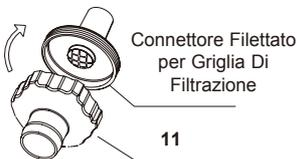
Avvitare l'adattatore del tubo B (11) al connettore d'inserimento, dall'interno della piscina.
